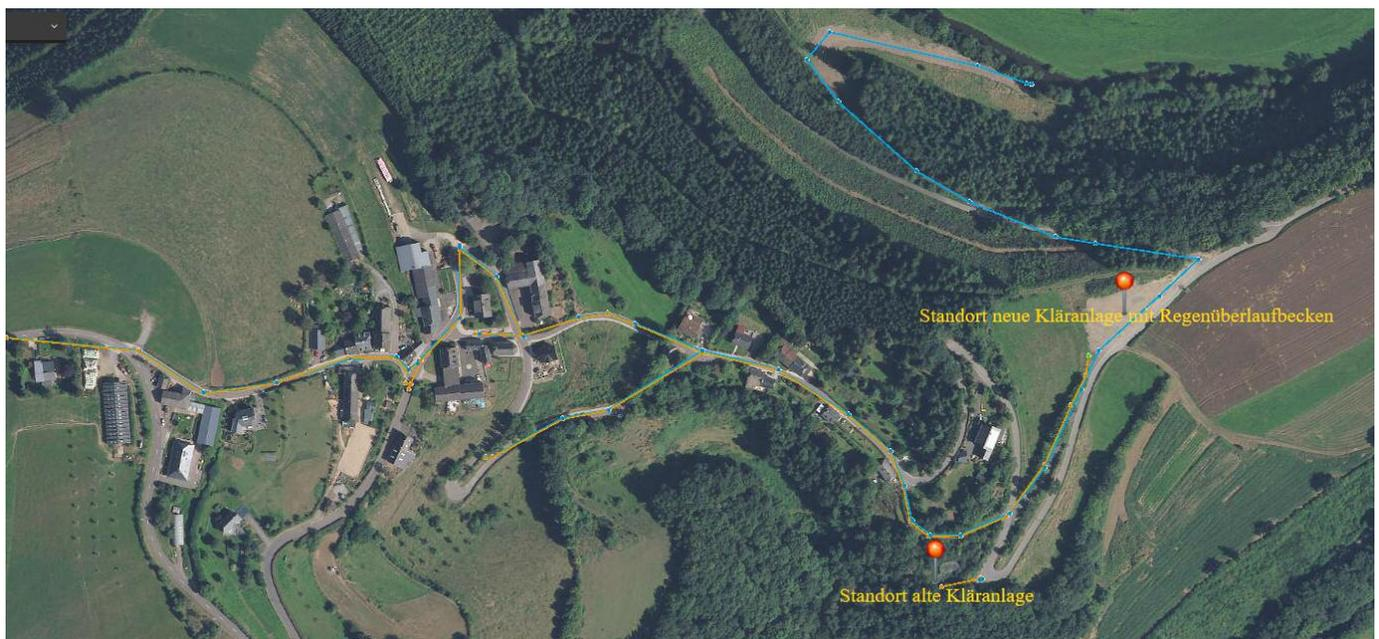
Bereits im Jahre 2008 wurde in Kautenbach eine moderne Kläranlage in Betrieb genommen. Hierbei handelt es sich um eine biologische Kläranlage (Biodiscverfahren) mit einer Kapazität von 1.000 Einwohnergleichwerten. Ein Einwohnergleichwert ist die im Durchschnitt tägliche erzeugte Schmutzfracht von einem Einwohner.
